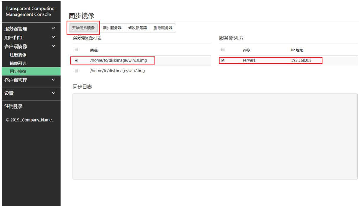
同步镜像过程中，页面会显示当前正在同步的镜像名称，同步镜像目标服务器地址和同步镜像的进度信息。
