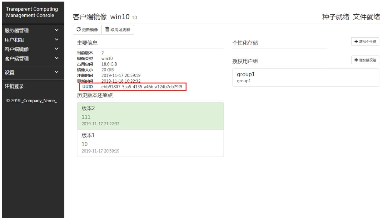
UUID 释义：点击蓝色字体“UUID”，可修改镜像的 UUID，如果修改为 UUID 已经在客户端下载过的镜像 UUID，则本次客户端登录不需要再次下载，运行的是该 UUID 的对应的镜像（例如：新注册一个 win7 镜像，版本为 1，UUID 为 123456，客户端登录下载 win7 镜像，然后把 win7 镜像更新到版本 2，UUID 为 654321，把版本 2 的 UUID 修改为 123456，这个时候客户端再次登录 win7 镜像，则登录的是版本 1 的镜像文件，并且不需要下载镜像）
