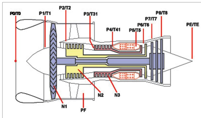
Figure 13.11 Triple spool front fan turbojet
